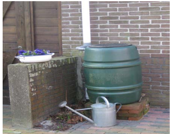
Различите врсте резервоара за складиштење кишнице за употребу у домаћинству
