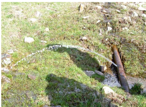
Корозија може проузроковати озбиљна цурења у дистрибутивном систему
