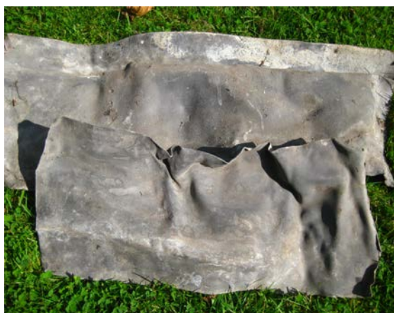
Олово је тежак и ковљив метал и раније се користио за производњу сервисних линија и калаја за лемљење. Олово је токсични метал за људе
