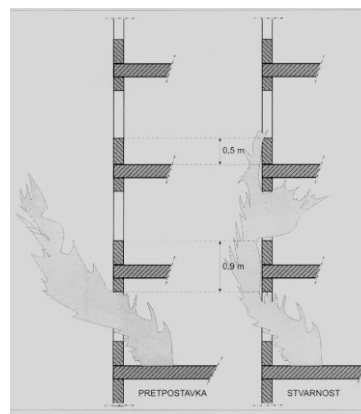
Slika 1. Pretpostavka i moguće realno kretanje požara po ravnoj fasadi[30]
