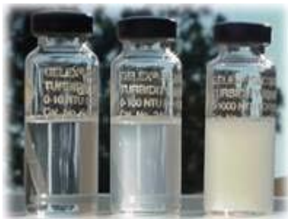
Узорци стандарда замућености са 5, 50 и 500 НТУ. Извор: http://en.wikipedia.org/wiki/Turbidity
