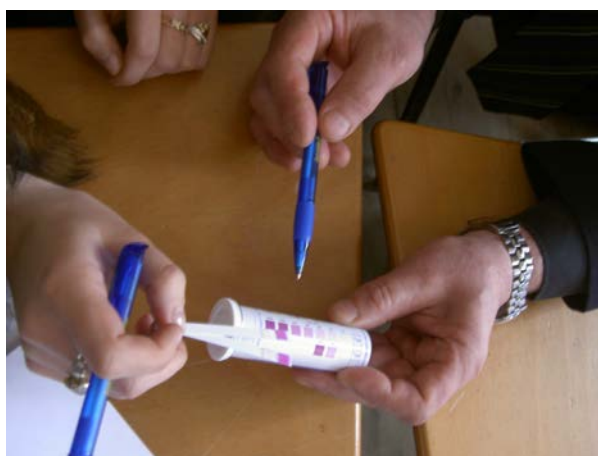
Тест траке на нитрате су јефтине, а узорци воде се брзо анализирају
